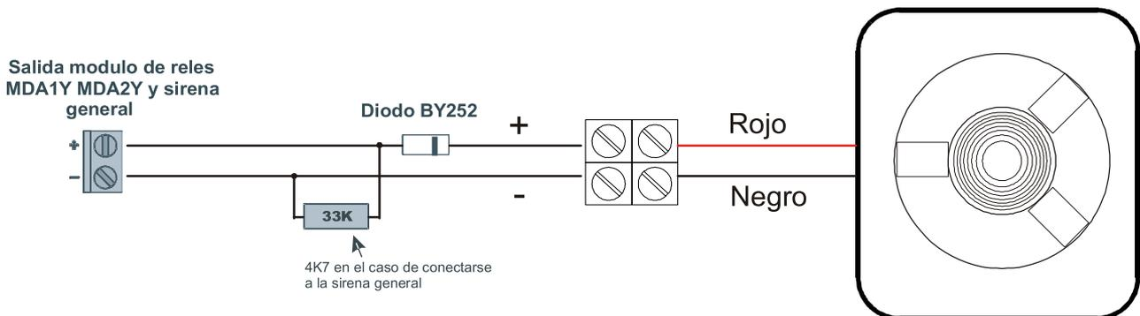
Figura 21. Esquema conexión SIR24F
