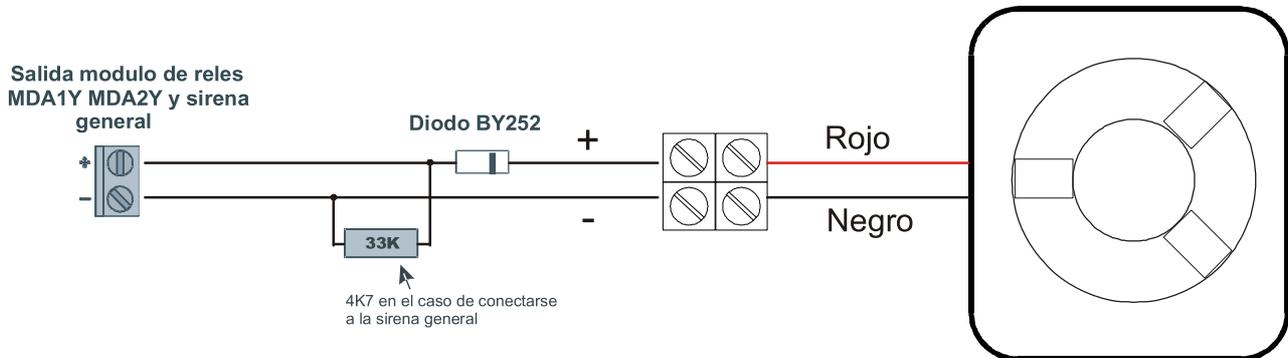
Figura 20. Esquema conexión SIR24P
