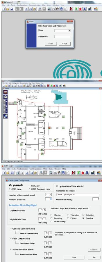
EASY CoNET es un Software de ayuda para la programación y la monitorización del estado de las centrales Lyon, Zafir y Compact Lyon de Cofem. Con la entrada en el mercado de centrales que pueden controlar más de mil puntos, es necesario un sistema eficaz de etiquetado y programación que haga más fácil, más rápido y más intuitivo el trabajo con la central.
