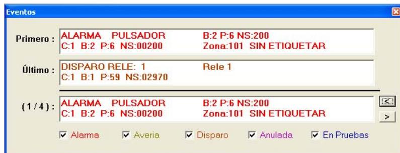
Mediante las casillas inferiores se puede seleccionar el tipo de anomalías que se desea ver. En el caso de que se produzca una alarma y estas no estén visibles se activarán automáticamente para que no pasen desapercibidas.
