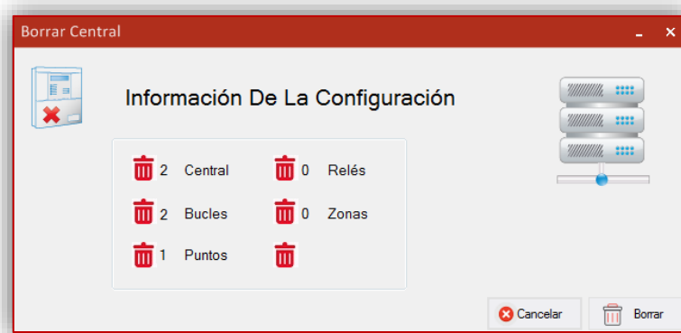
Figura 14. Menú que muestra la información de la configuración de la central a eliminar.
