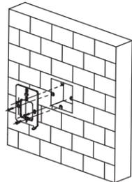
3 将设备扣入挂板，并在设备左下角用1枚螺丝（M3）固定设备与安装挂板。
