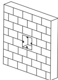
2 用配件包中的螺丝（M4）将安装挂板固定在86盒上。整理线缆，确定出线方式。
