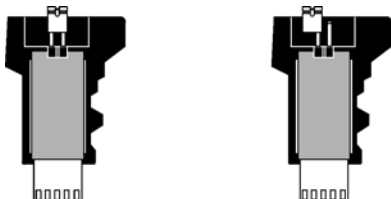
Figura 23: Configuración del Puente de PMC-4 Puente ON Puente OFF
