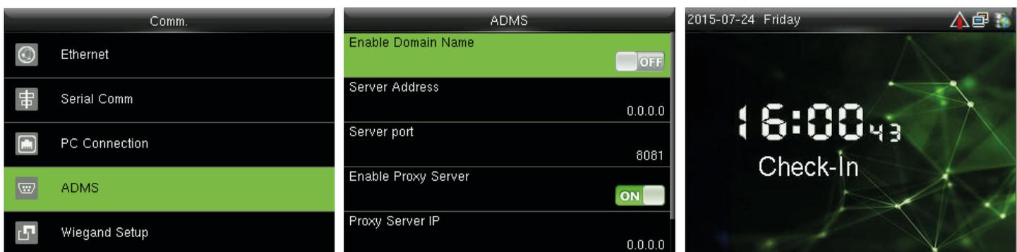
En la interfaz inicial, pulse **[M/OK] > Comm. > ADMS** para entrar en la interfaz de configuración del servidor de ADMS. Cuando el servidor Web está conectado correctamente, la interfaz principal mostrará el logotipo.
