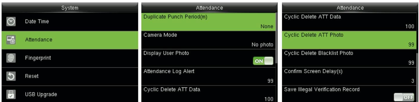
En la interfaz inicial, pulse **[M/OK] > Sistema > Asistencia** para entrar en configuración de la interfaz.
