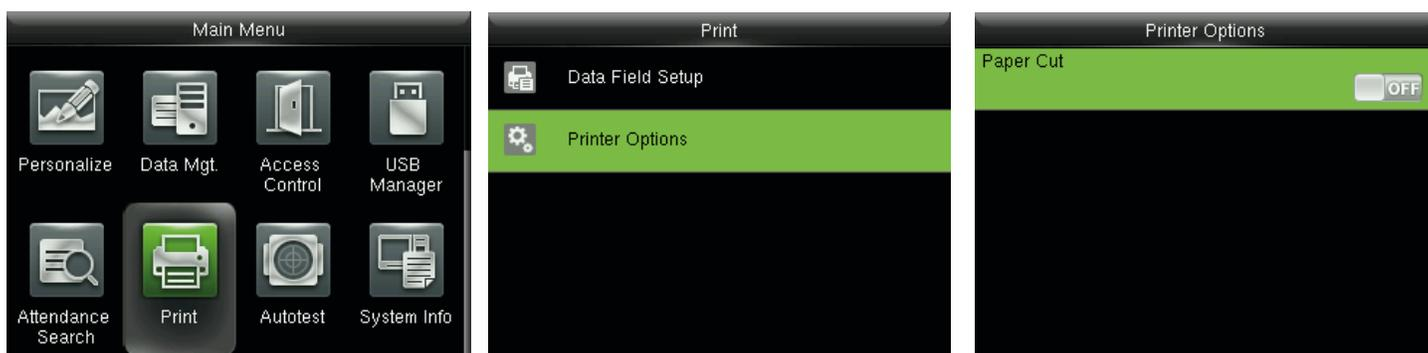
En la interfaz inicial, pulse [M/OK] > **Impresión** > **Imprimir** > **Opciones** > pulse [M/OK] para activar/desactivar la función de corte de papel.
