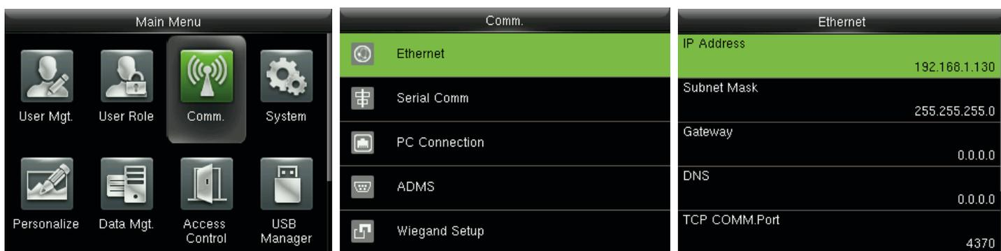
En la interfaz inicial, pulse **[M/OK] > Comm. > Ethernet** para entrar en la configuración de la interfaz Ethernet.
