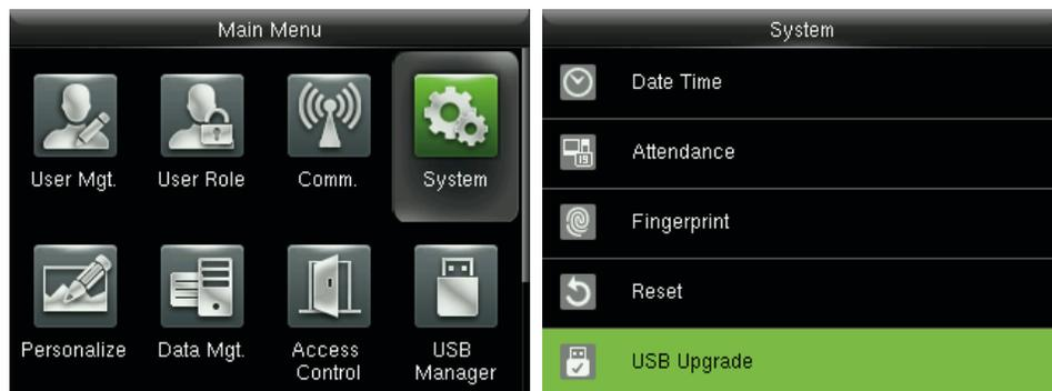
Inserte el disco con el archivo de actualización en el puerto USB del dispositivo, y en la interfaz inicial, pulse **[M/OK] > Sistema > Actualización USB** para completar la operación de actualización de firmware.
