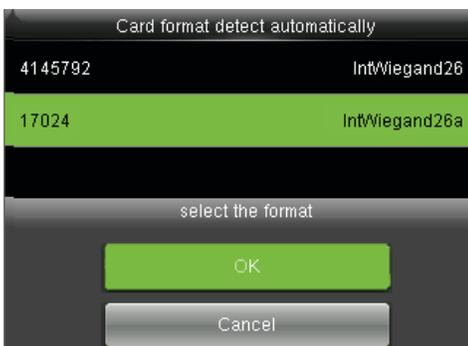
2. Elija el elemento correspondiente al número de tarjeta real del dispositivo [Formato Wiegand], que es el formato Wiegand para leer este tipo de tarjeta.
