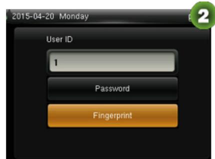
Presione Huella y después **[M/OK]**, coloque el dedo después en el sensor.
