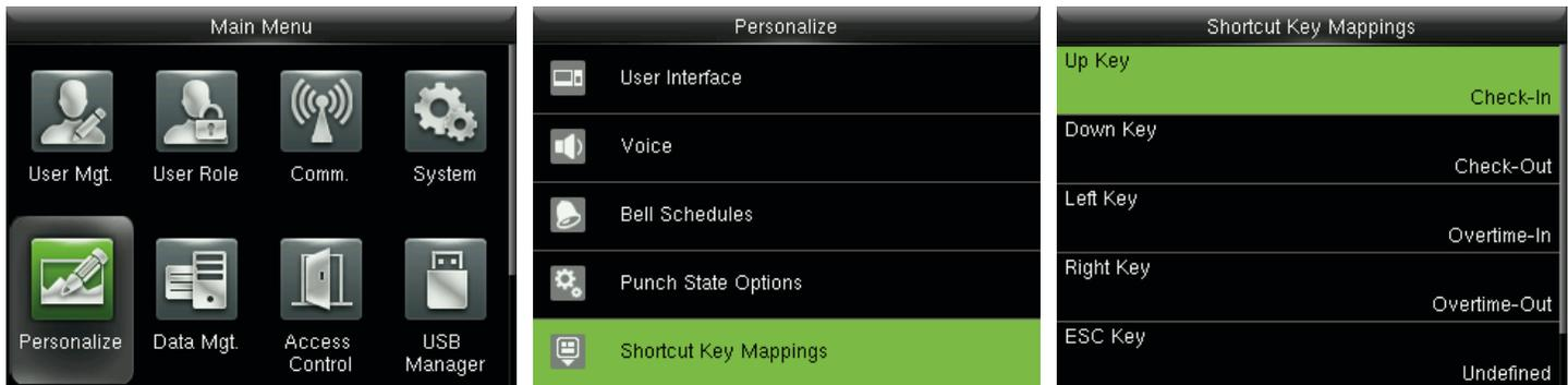
En el interfaz inicial, pulse **[M/OK] > Personalizar > Asignaciones de teclas de método abreviado** para entrar en la interfaz de configuración de las asignaciones de teclas de método abreviado.
