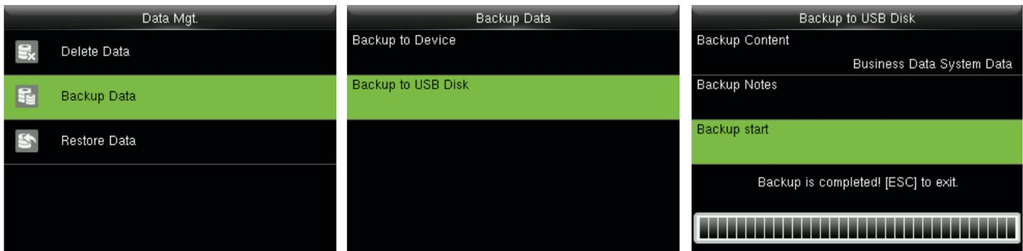
Inserte el disco USB. En el interfaz inicial, pulse **[M/OK] > Gestion de Datos > Copia de seguridad > Respaldo a USB > Respaldo de Datos** > Elegir contenido para ser respaldados (datos de empresa/datos del sistema) > Copia de seguridad de inicio para iniciar la copia de seguridad. Reiniciar el dispositivo no se necesita después de la copia de seguridad se ha completado.
