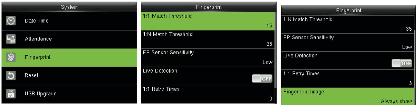
En la interfaz inicial, pulse **[M/OK] > System > Huellas Digitales** para entrar en la configuración de la interfaz.
