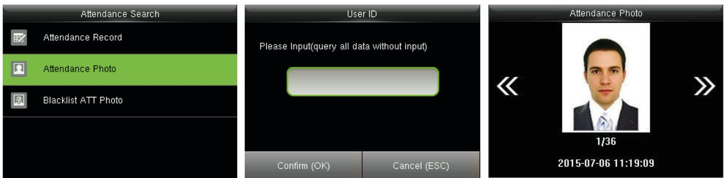
En la interfaz inicial, pulse **[M/OK] > Búsqueda de Asistencia > Asistencia > Fotos** búsqueda introduzca el ID de usuario (si no se introduce un código, todos los asistentes fotos serán buscados) > seleccione el **Rango de Tiempo** > pulse **[M/OK]**, la correspondiente asistencia fotos será mostrada.
