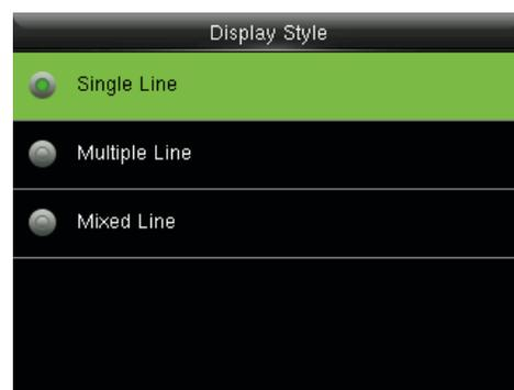
En la interfaz inicial, pulse **[M/OK]** > **Usuario Mgt.** > **Estilo de visualización** para entrar a la configuración de estilo de visualización de la interfaz.
