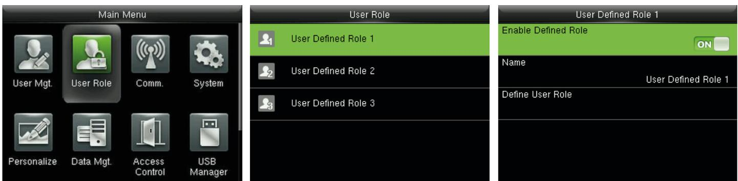
En la interfaz inicial, pulse **[M/OK] > Función de usuario > Función definida por el Usuario 1 (2 / 3) > Activar función definida**, pulse **[M/OK]** para habilitar la función definida.
